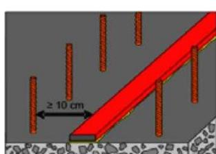
Установленный профиль SikaSwell® - A Profile, до заливки его бетонной смесью, необходимо защищать от воздействия дождя.
