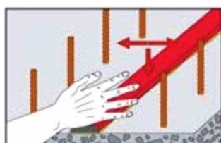
Профиль SikaSwell® - A Profile должен закрываться слоем бетона толщиной не менее 10 см.
