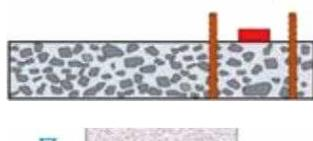
При заливке бетонной смеси вокруг профиля SikaSwell® - A Profile необходимо тщательно укладывать бетонную смесь, так, чтобы не образовывалось дефектных мест, пустот, непровибрированных недоуплотненных мест.
