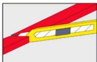
SikaSwell® - A Profile возможно приклеить на набухающий герметик SikaSwell S-2, клей Sikadur 31 или клей SikaBond AT-Universal
