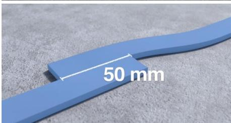
Соединять концы следует внахлест 50 мм. или стык в стык. При соединении концов стык в стык наложите рядом со стыком заплатку длиной не менее 30 мм.
