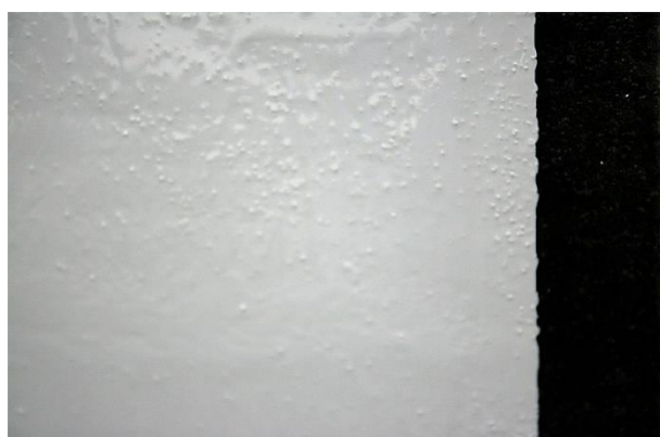
Рис. 16. Вид поверхности после нанесения 3-го слоя мастики. Для 3-го слоя здесь применялась мастика Гипердесмо серого цвета.
