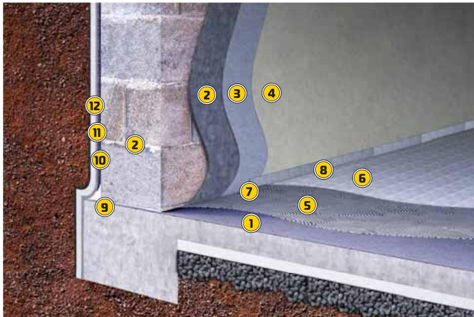
**Нанесение:** кисть-макловица с жёсткой щетиной из искусственного ворса, малярный валик либо распылитель для вязких составов (с последующим заглаживанием кистью во взаимно-перпендикулярных направлениях). Нанесение в два прохода, толщина нанесения за один проход 1 мм. Общая толщина слоя 2мм. Слои наносятся во взаимно перпендикулярных направлениях.
