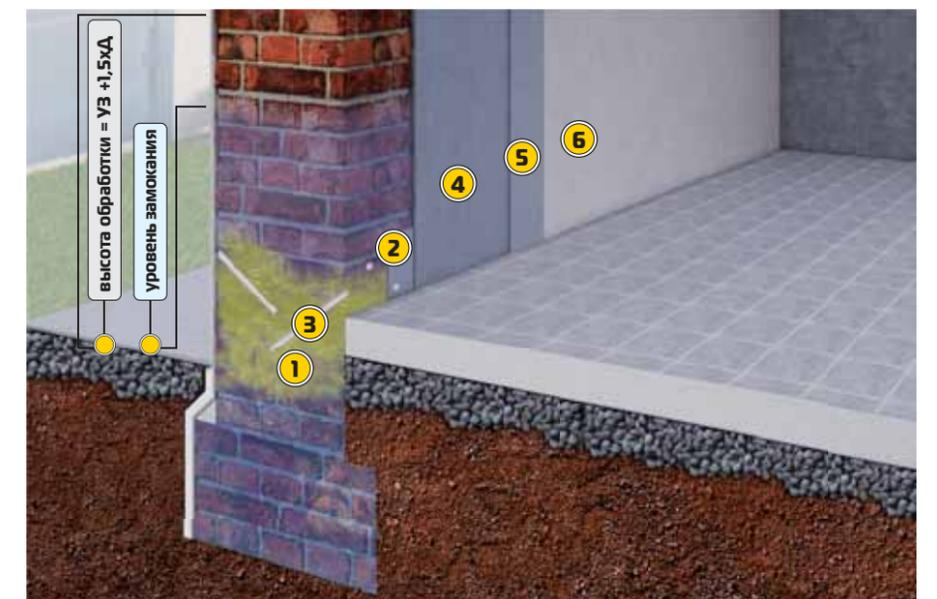
видимых повреждений вызванных влагой, нужно определить необходимую высоту для нанесения реставрационных материалов. Для измерения этой высоты нужно умножить высоту видимого уровня влаги на стене на 1,5. В зависимости от содержания и количества влаги избирается специальный тип реставрационной штукатурки.
