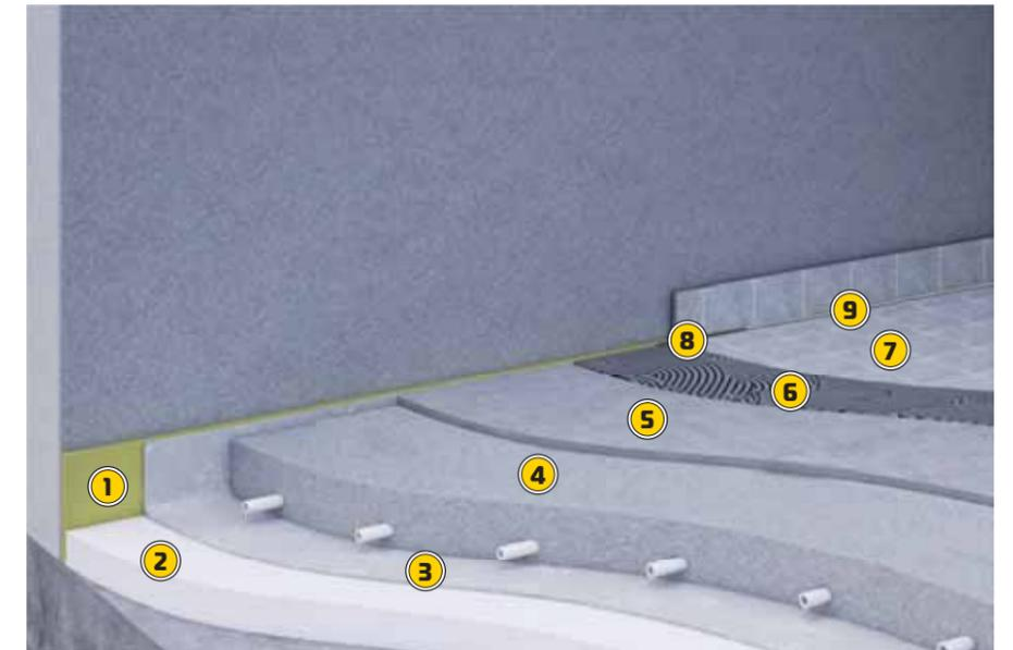
24 часа никаких следов влаги не видно, постепенно снижайте температуру. За 2-3 дня до начала работ отключите нагрев или поддерживайте комнатную температуру в 18° С. Через три дня после укладки напольного покрытия начинайте постепенный нагрев пола до рабочей температуры.
